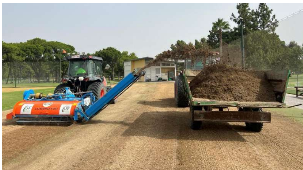
Foto 5. Máquina Koro que se encarga de realizar el decapado del AG del chipping green. Con esta misma máquina se realizará el decapado de los collares de bermuda de la primera vuelta.
